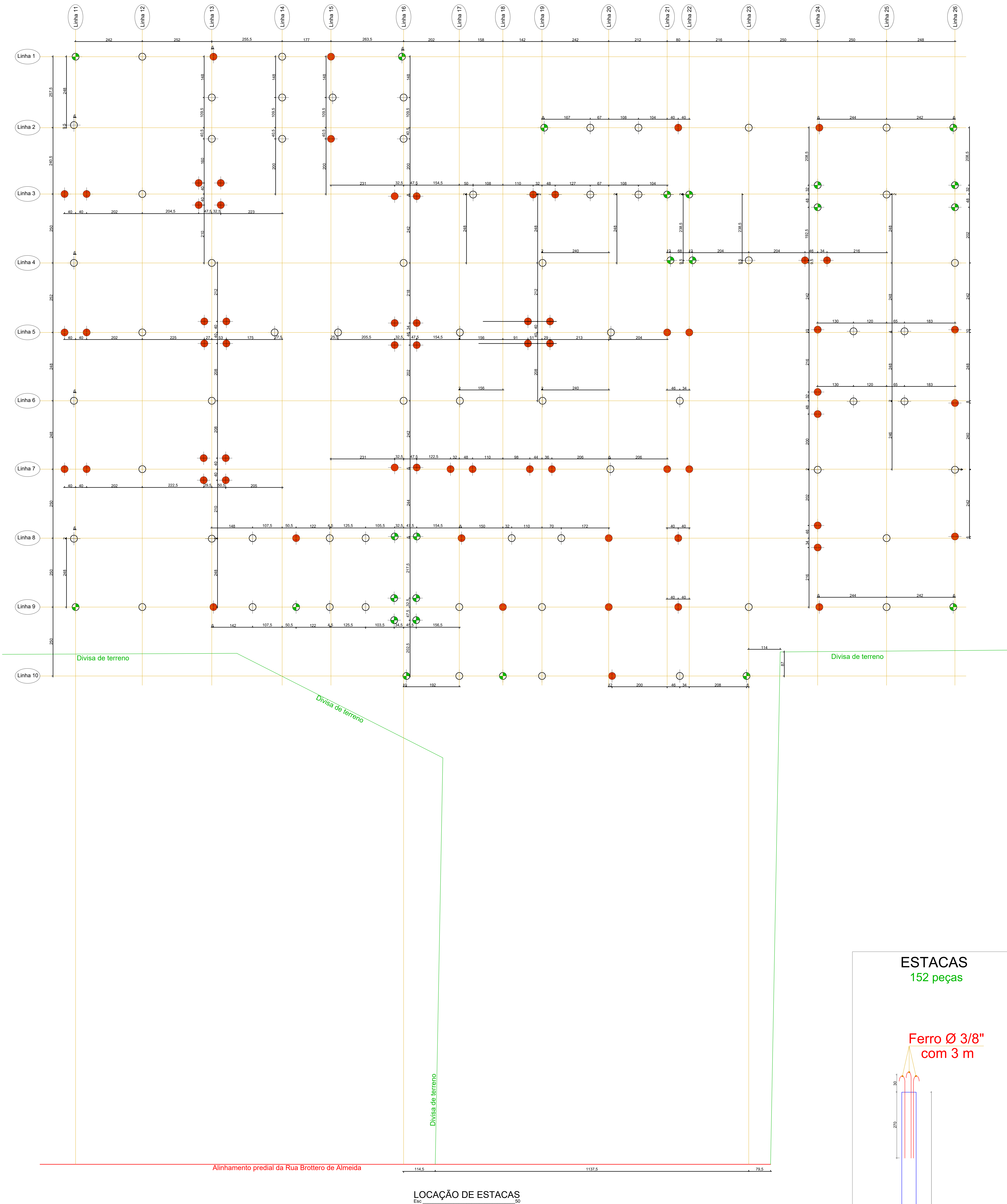
LOCAÇÃO DE ESTACAS
